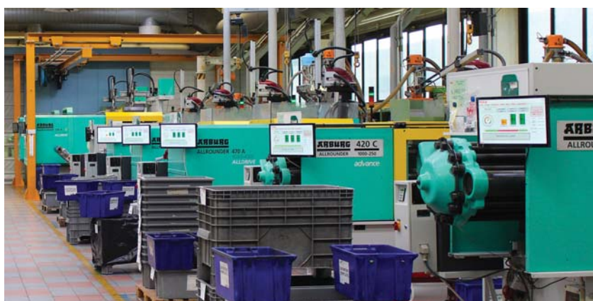
Sistema dashboard a bordo macchina nello Stabilimento ROLD
